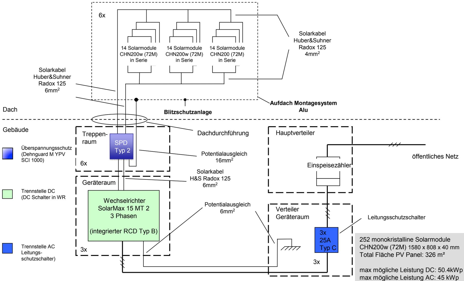
**Prinzipschema Photovoltaik Anlage**
