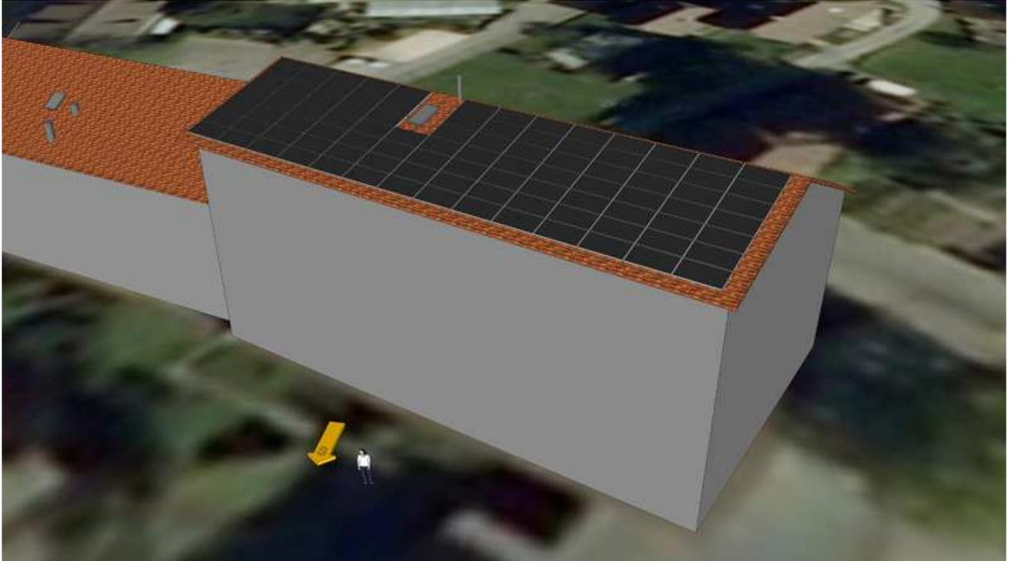
Solarmodule: 93 monokristalline Solarmodule CHN200w (72M) 1580 x 808 x 40 mm
